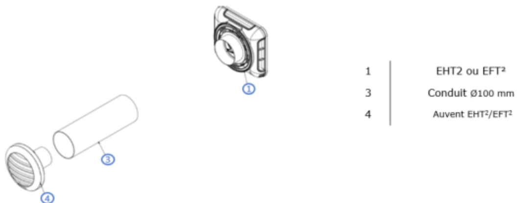
Figure 24 – Mise en œuvre entrée d'air EHT² et EFT² sans mousse Ø 100 mm L 300 mm
