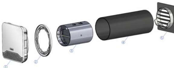
Figure 27 – Mise en œuvre entrée d'air EHT 2 ou EFT 2 avec électrofiltre EHT 2 /EFT 2 sans mousse Ø 125 mm L 300 mm
