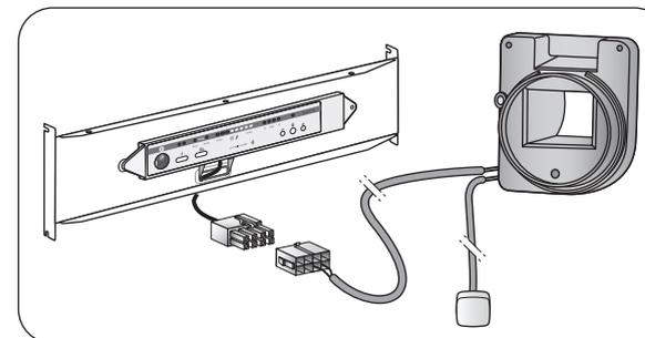
Raccorder le connecteur à la chaudière
