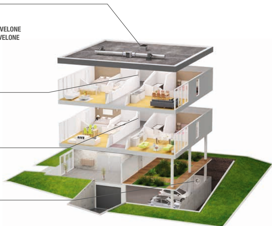
Coffret de désenfumage parking Ventilateur hélicoïde de ventilation et de désenfumage HELIONE
