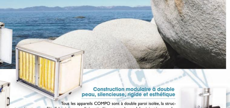
ture étant en profilé d'aluminium anodisé, articulée autour de modules injectés en polypropylène renforcé. Les panneaux sont pré-peints (RAL9002) et recouverts d'un film plastique de protection à retirer après l'installation, et sont aisément démontables pour accéder aux organes internes. Cette combinaison permet l'exposition des panneaux aux intempéries, et forme un ensemble rigide.
