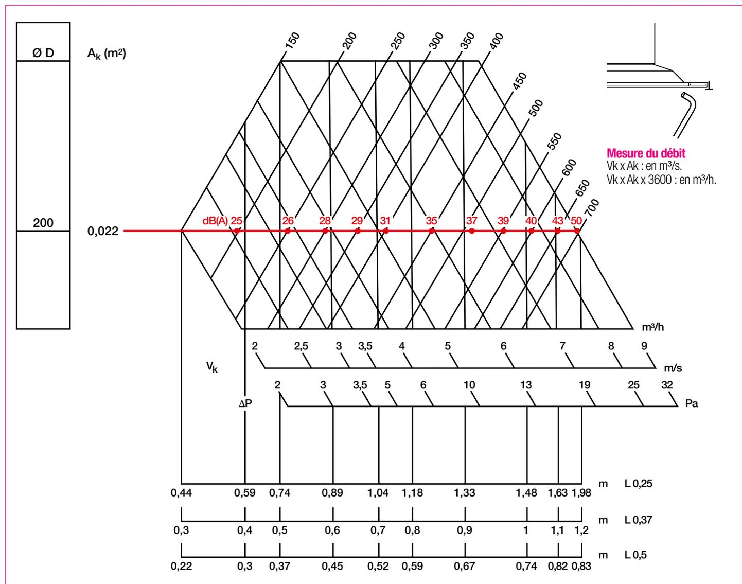
Les valeurs L<sub>w</sub> (dB(A)) ne tiennent pas compte de l'atténuation du local. Tests réalisés avec le plénum standard.
