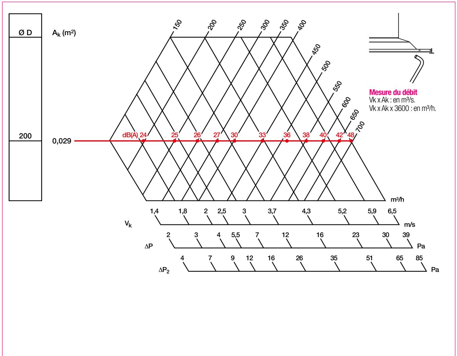
Les valeurs L<sub>w</sub> (dB(A)) ne tiennent pas compte de l'atténuation du local. Tests réalisés sans plénum (modèle vrac ø 250) et avec le plénum standard (Pa2).
