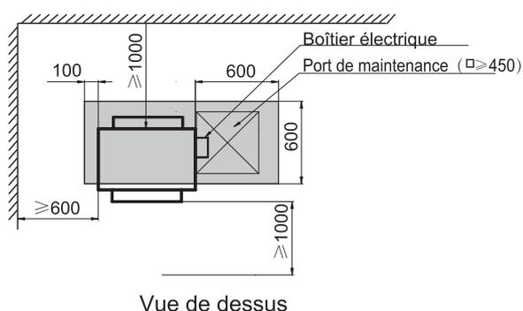
1. Il est conseillé de prévoir un port de maintenance lorsque le plafond n'est pas démontable.
