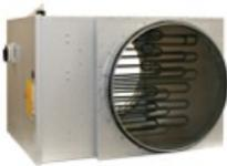
La batterie de dégivrage est électrique, pilotée par la CTA VEX. Elle est externe, montée sur le conduit d'air extrait, à minimum 50cm de l'orifice de la CTA.
