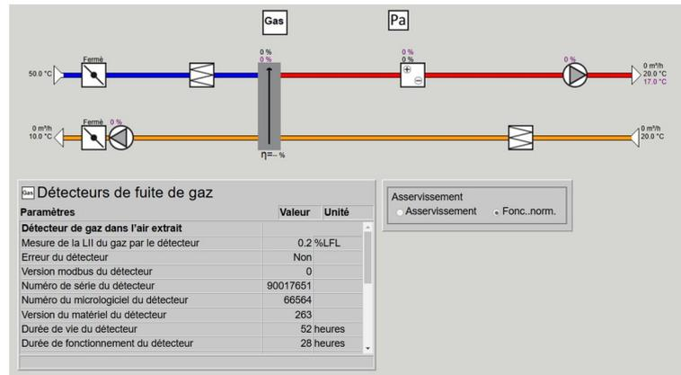
En cas de détection d'une fuite de gaz, l'appareil émet une alarme et commence à diluer la fuite de gaz en suivant le schéma de procédé suivant :
