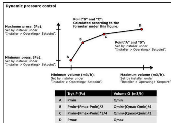
Pour la régulation du ventilateur à « Pression dynamique » (aDCV) sans air de recyclage modulé, ce qui suit est applicable :
