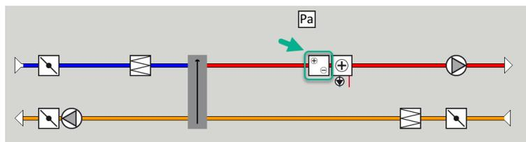
Le refroidissement DX et la pompe à chaleur RHP (Reversible Heat Pump) sont munis d'un ou de deux compresseurs. La première étape est toujours modulante et une éventuelle deuxième étape fixe. Un transmetteur de pression doit être installé dans le circuit de refroidissement pour la mesure de la pression basse et élevée dans le circuit de pression DX.
