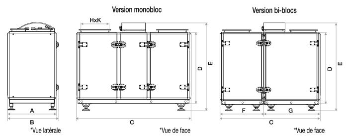
La cotation M représente l'espace nécessaire pour effectuer la maintenance de la centrale (changement moteurs, filtres...). La cotation S représente l'espace nécessaire pour effectuer le changement de l'échangeur de chaleur.
