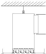
Diffuseur de soufflage avec fixation S2
