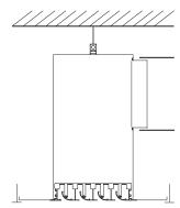
Diffuseur de soufflage avec fixation S2
