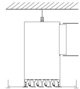
Diffuseur de soufflage avec fixation S2
