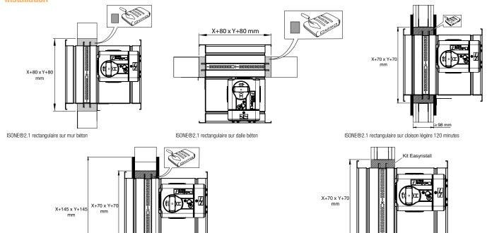
ISONE®2.1 rectangulaire sur cloison carreaux de platre 120 minutes
