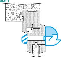
Mise en œuvre entrée d'air EAI
