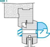
Mise en œuvre entrée d'air EAI
