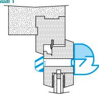
Mise en œuvre entrée d'air EAI
