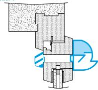
Mise en œuvre entrée d'air EAI
