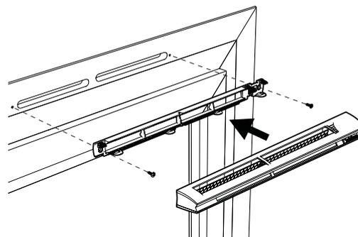
Mise en œuvre entrée d'air EHB2
