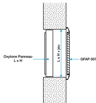
Principe de mise en oeuvre en maçonnerie
