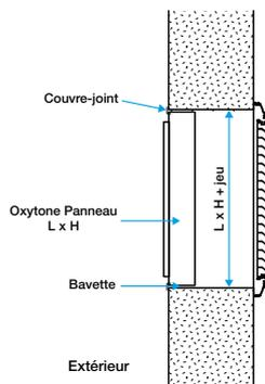
Principe de mise en oeuvre en maçonnerie
