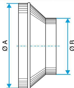
Schéma d'encadrement Réduction Conique Concentrique
