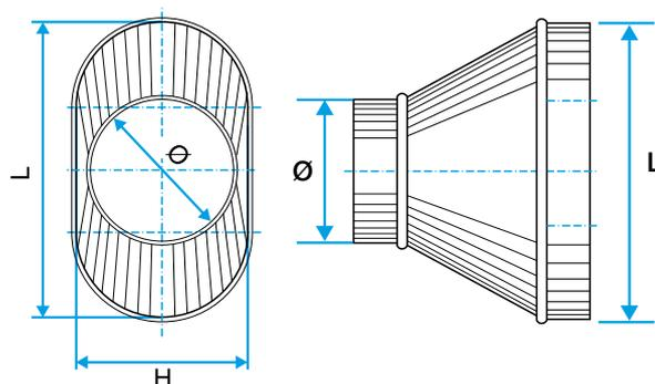
Schéma d'encombrement Réduction Concentrique Oblongue Cylindrique
