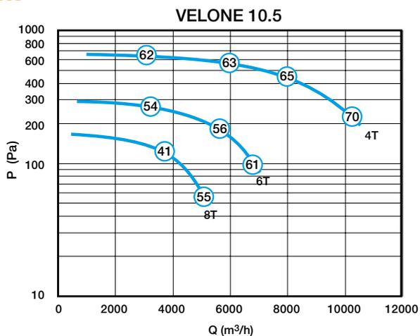
> courbes suivant NF EN ISO 5801, aspiration raccordée (Ø 450 mm),
